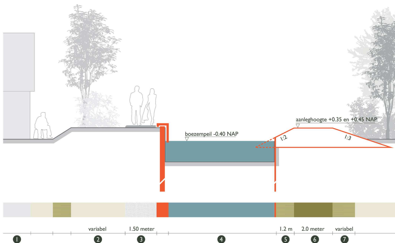
Afb. 8.13: Principeprofiel bij tuindershuisjes en gemaal
